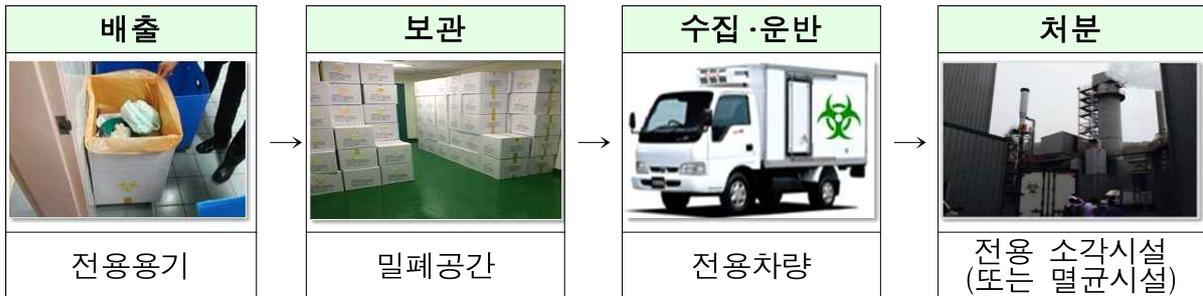
※ 의료폐기물 전용용기에 RFID(무선주파수 인식방법) 전자태그를 부착하여 의료폐기물 발생~처리 전 과정을 실시간으로 관리
