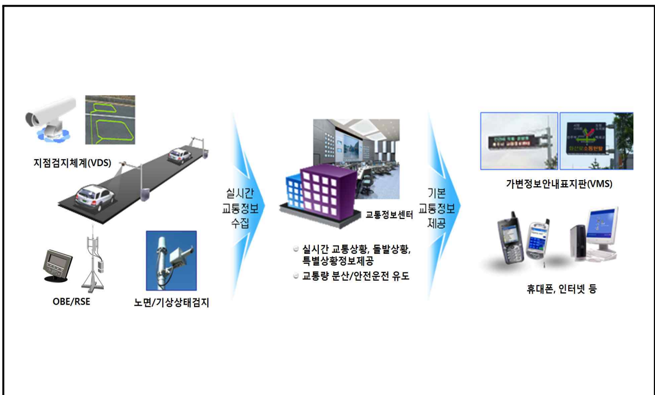
<그림 6-6> 교통정보수집시스템 및 교통정보제공시스템의 개념도
